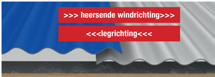
Doorsnee: voorbereiden van acrylaat lichtplaten
